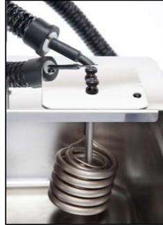
浴槽上的调节平板，允许安全固定冷却盘管
